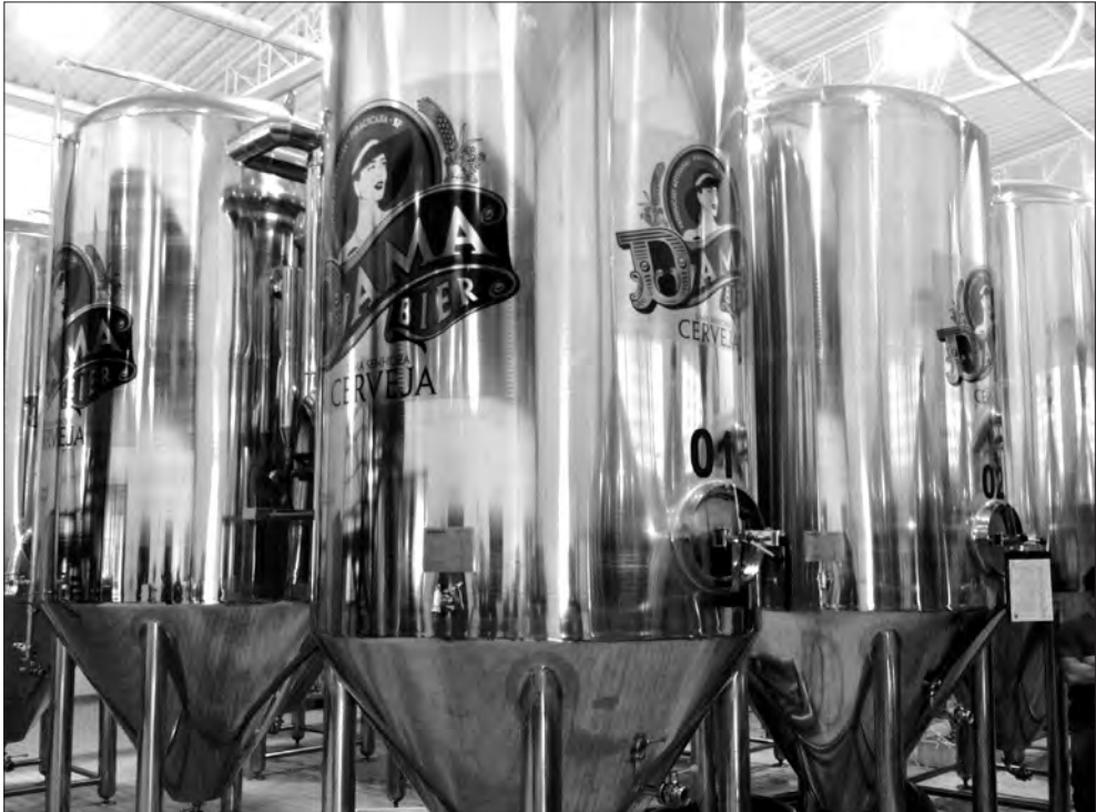
Figura 4 - Serbatoi di fermentazione raffreddati con glicole presso Dama Bier, a Piracicaba, San Paolo, Brasile.
